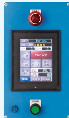
フレアマシンの操作パネル
